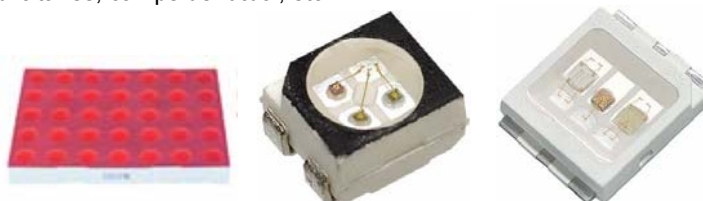
Figura 45. Matriu de leds. Actualment es fabriquen leds amb el tres colors primaris dintre del mateix encapsulat.
